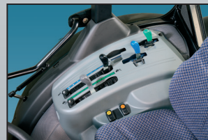
Hensigtsmæssig placering af håndtag til lift og olieudtag
