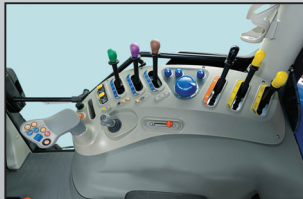
Multifunktionshåndtag hvor mange af de vigtigste funktioner kan betjenes
