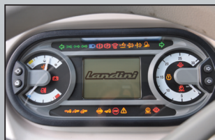
Instrumentbord med integreret arealmåler
