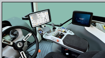
Multifunktionsarmlåen hvor alle de vigtigste funktioner kan betjenes samt 12" touchskærm er standard.
